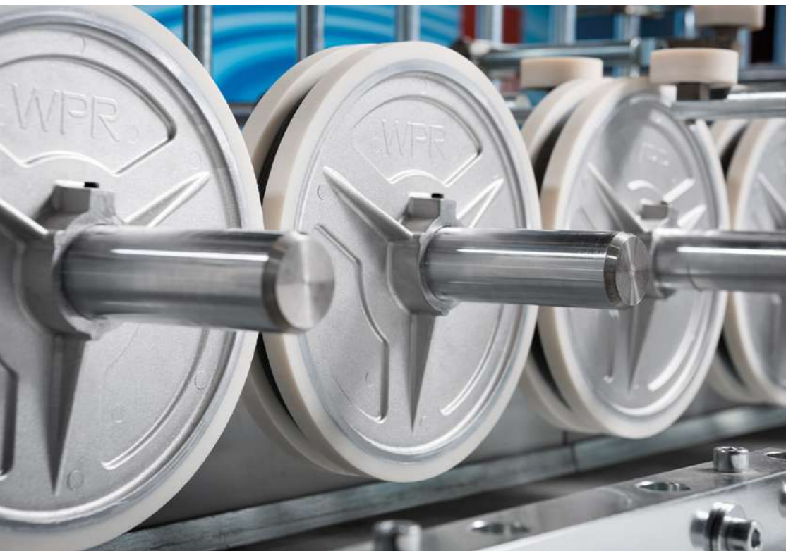
Antriebsrollen mit hitzebeständiger Antihaft-Beschichtung
